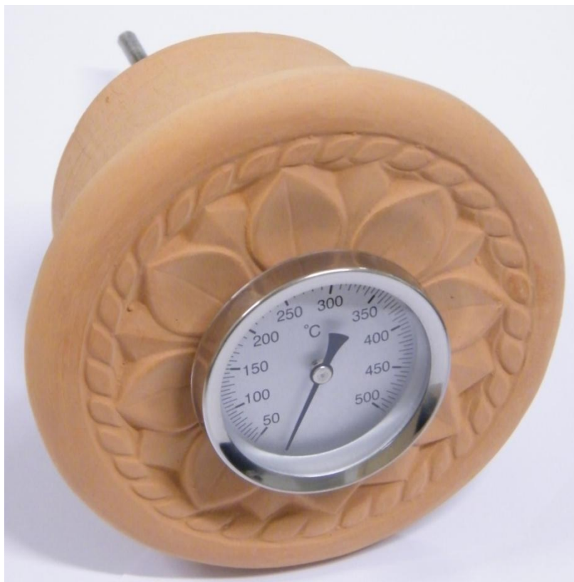
Joonis 4 Suitsugaasi termomeeter paigutatud läbi tahmatopsi Figure 4 Flue-gas thermometer in soot hatch
