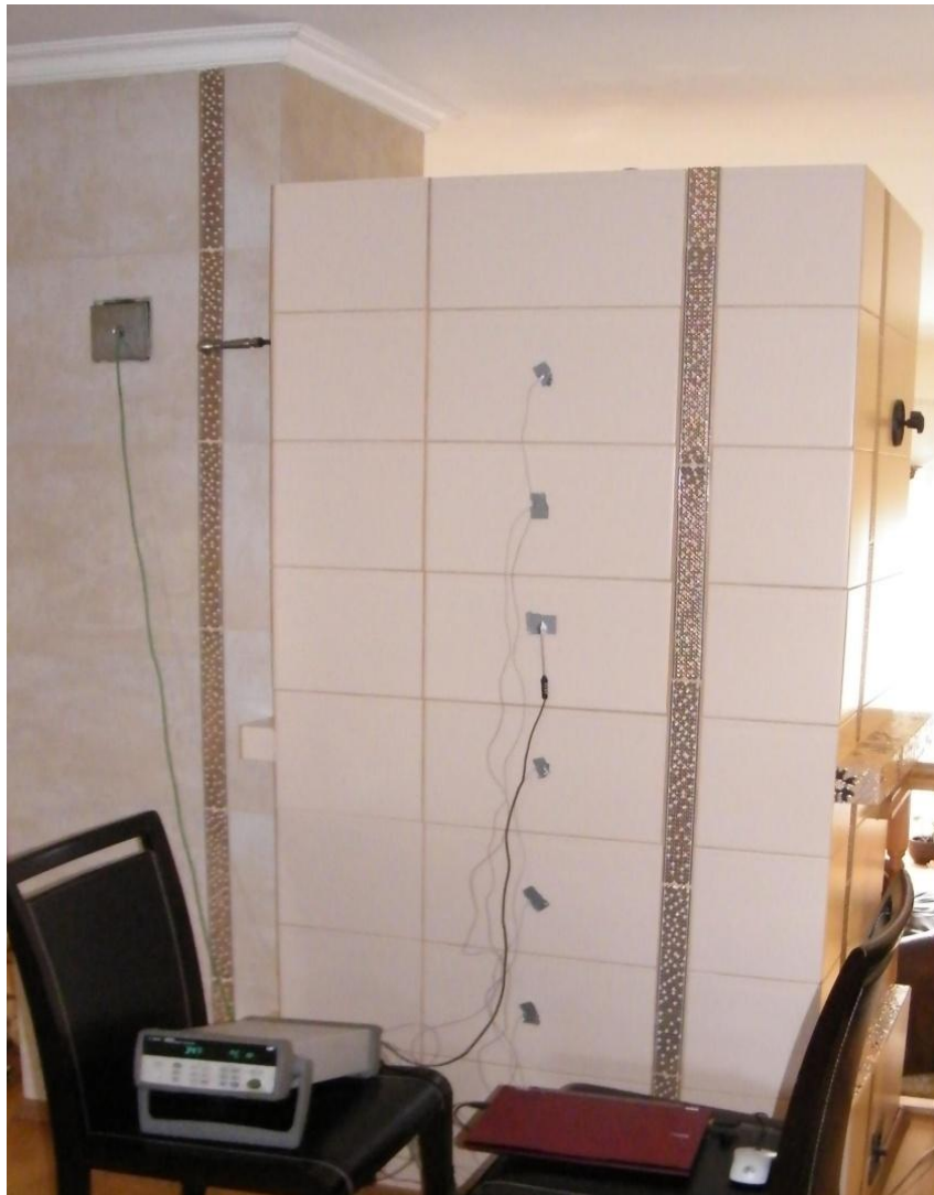
Joonis 2 Moodulahju pinnatemperatuuride mõõtmise üldvaade Figure 2 Surface temperatures measurements of modular oven
