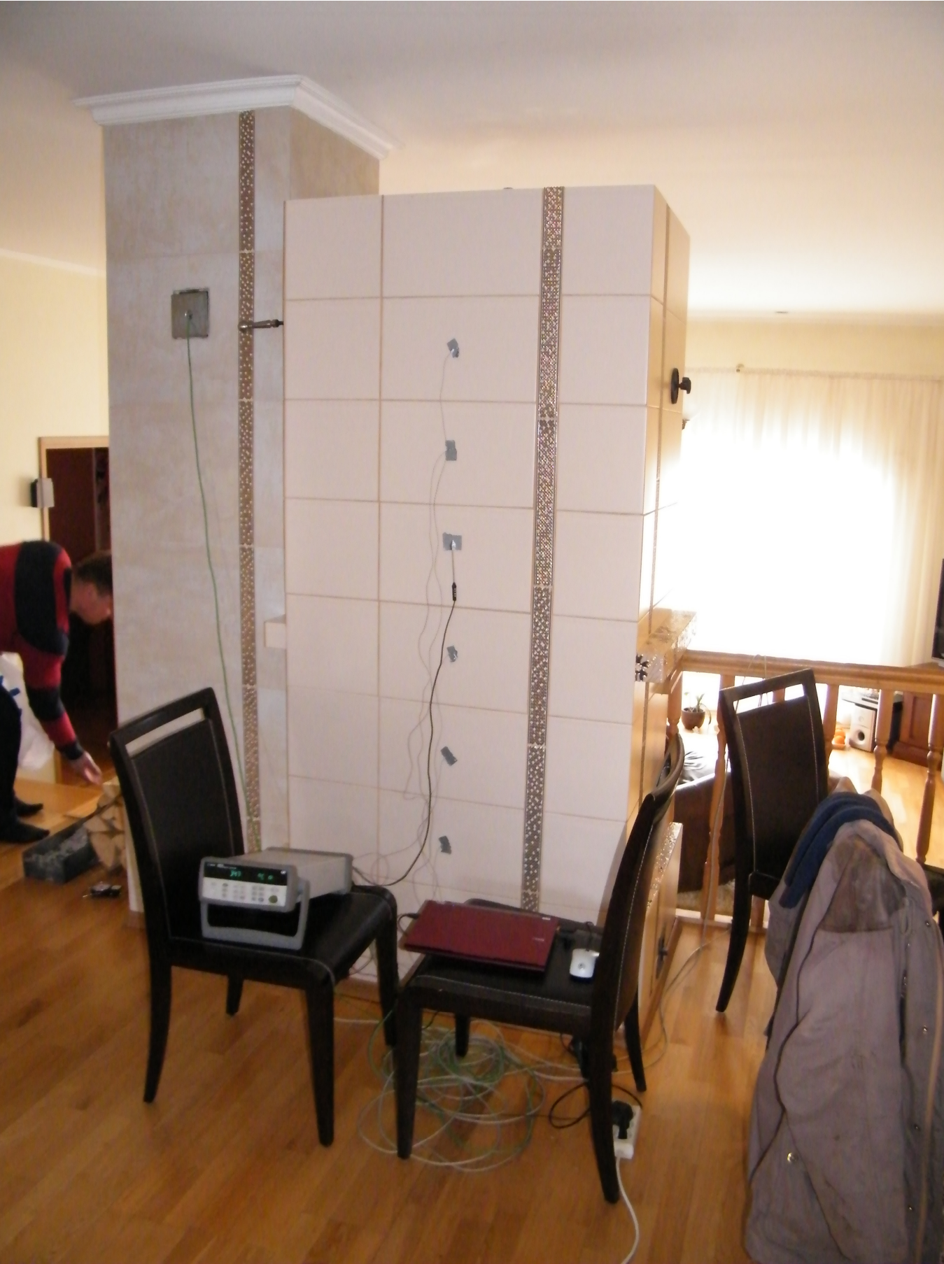
Joonis 2 Moodulahju pinnatemperatuuride mõõtmise üldvaade Figure 2 Surface temperatures measurements of modular oven
